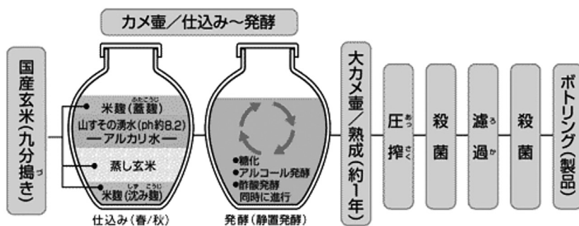
図2 壺の中での3つの反応と製造工程
