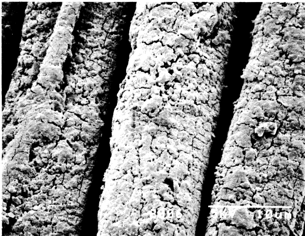
写真-1 泥染大島紬(O-D-2)表面の走査電子顕微鏡写真
